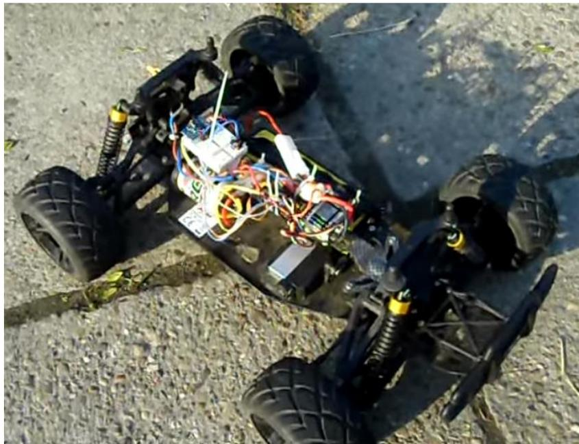
Ilustración 8. ESP8266 WiFi RC car <sup>8</sup>
