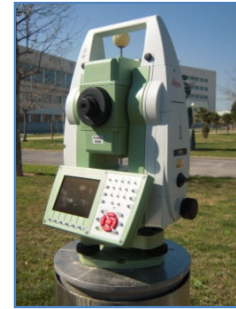
Imágen 53 - TS15 en base de calibración
