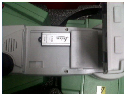
Imagen 34 - Detalle de la colocación del USB
