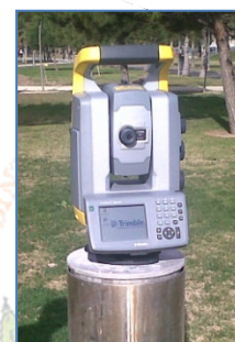
Imágen 52 - S6 en base de calibración
