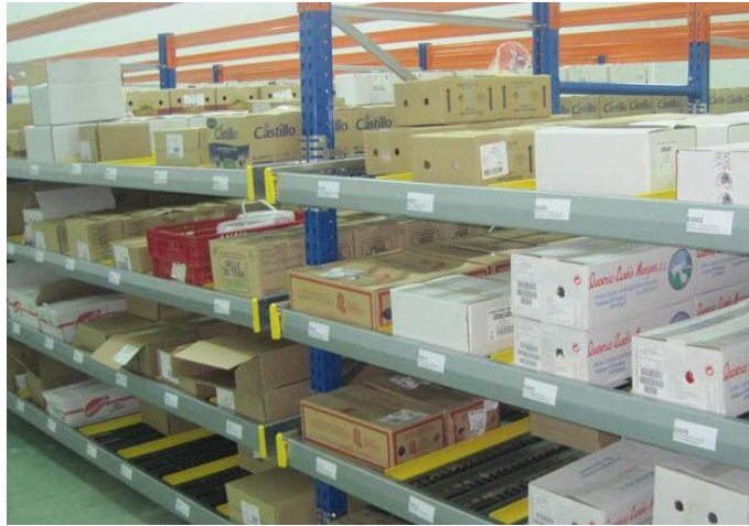
Figura 14. Estantería dinámica en uso (Fuente: Noegasystems (2016))
