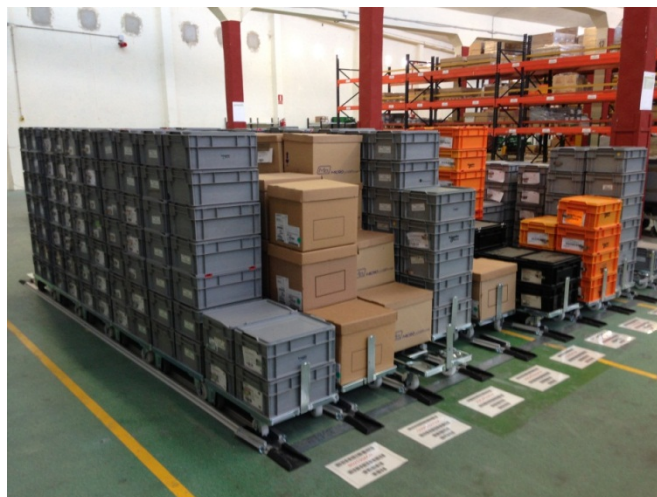
Figura 25. Flat Storage. Carros con material sobre raíles (Fuente: Schneider Electric (2016))
