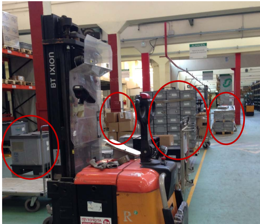
Figura 23. Materiales ocupando zonas no destinadas a almacenaje (Fuente: Schneider Electric (2016))
