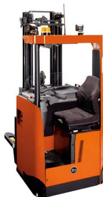
Figura 7. Apilador con hombre montado sentado (Fuente: Toyota-forklifts (2016))
