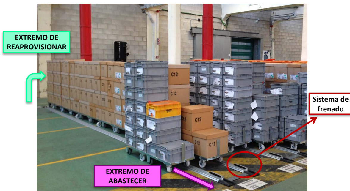
Figura 26. Flat Storage. Extremos del carril y sistema de frenado Fuente: (Schneider Electric (2016))
