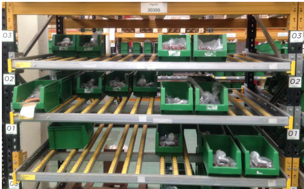
Figura 22. Estantería dinámica para picking con desaprovechamiento de la capacidad (Fuente: Schneider Electric (2016))
