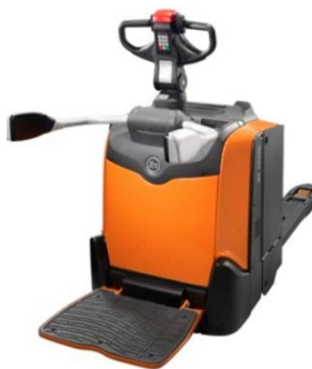
Figura 6. Transpaleta eléctrica con conductor de pie (Fuente: Toyota-forklifts (2016))
