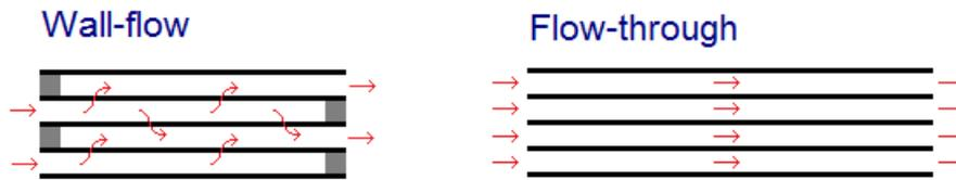
Figura 2.5: Esquema comparativo de la estructura wall-flow y flow-through.
