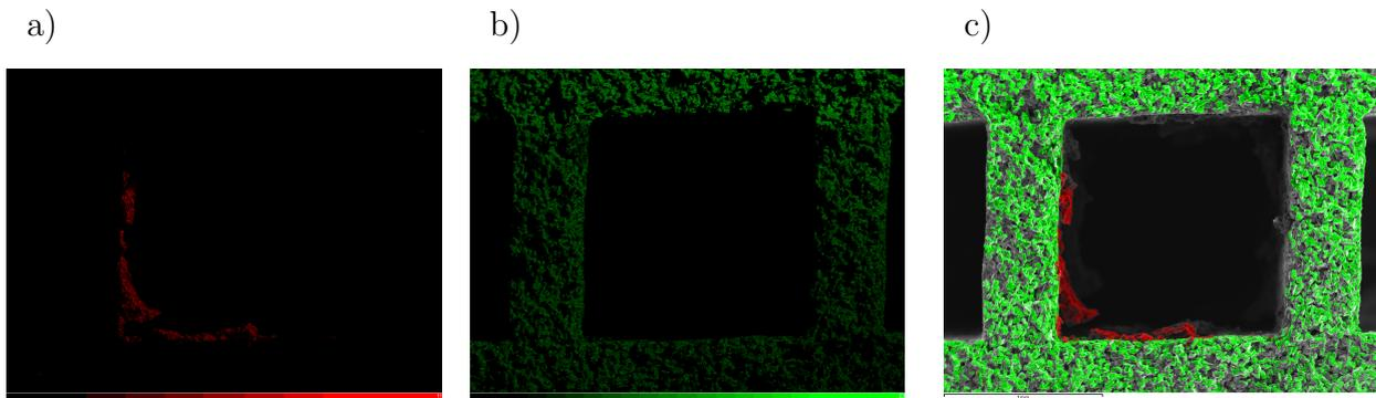
Figura 4.8: Ejemplo de aplicación de mapa de elementos: a) Carbono detectado; b) Silicio detectado; c) Carbono y silicio superpuestos en la imagen de electrones secundarios.
