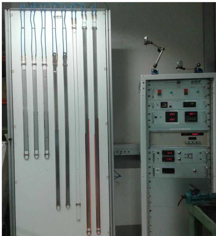
Figura 3.4: Instrumentos para la medida de pérdida de presión: A la izquierda columnas de agua y mercurio para la medida de saltos de presiones y a la derecha armario de control para modificar el gasto másico.
