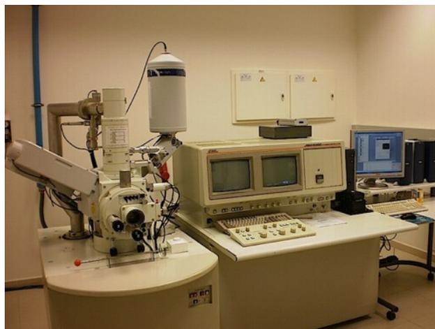
Figura 4.1: Microscopio electrónico de barrido utilizado para la obtención de imágenes.
