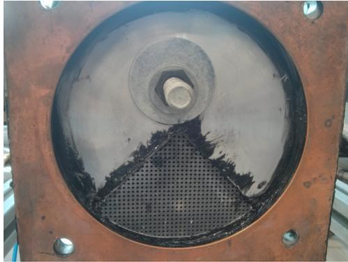
Figura 3.2: Estructura para el ensayo de los cuartos de DPF con un cuarto montado y sellado.
