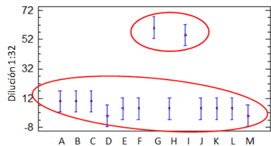
Figura 22. Media de los porcentajes de inhibición de la movilidad para la dilución 1:32 y para cada nivel de muestra, con el error estándar de cada media (LSD).
