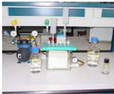
Figura 5. Sistema de extracción a vacío Extra Vac 12 (Scharlab) para cartuchos de SPE.
