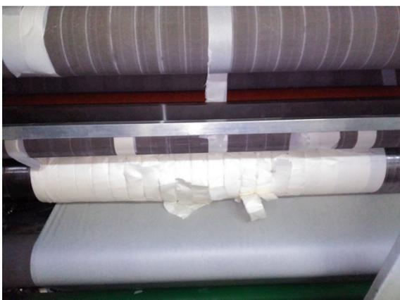
Figura 10: Rotura en tambor de bobinado
