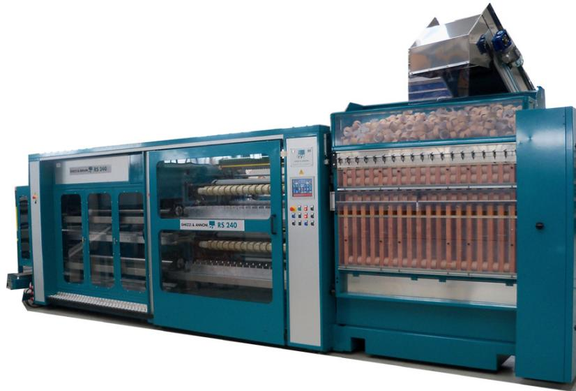
Figura 5: Módulo de desbobinado y corte
