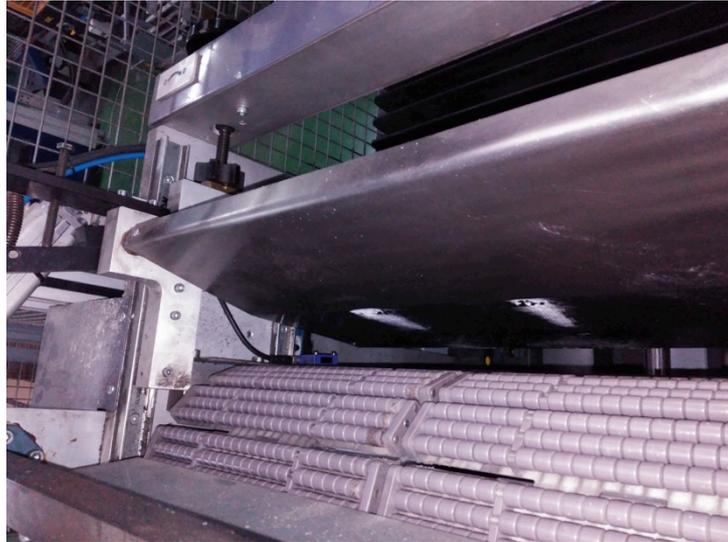
Figura 16: Plancha de caída encajado sucia
