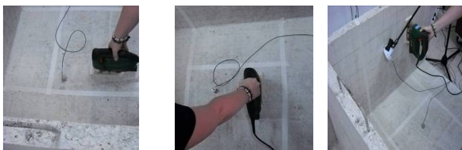
Figura 4.1.7. Detalle de alguna de las mediciones de los niveles de velocidad.
