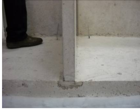
Figura 4.1.13. Detalle de la unión en T de la maqueta de hormigón.
