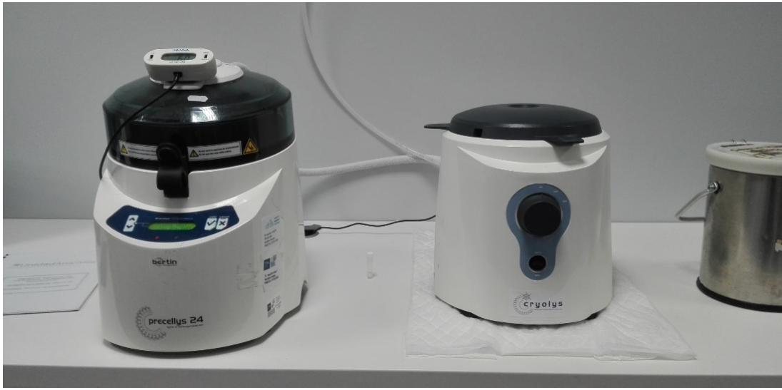
Figura 13: Dispositivo Precellys 24. Equipado con un termómetro dentro de la cámara de homogenizado para controlar la temperatura y un dispensador de nitrógeno líquido (derecha).
