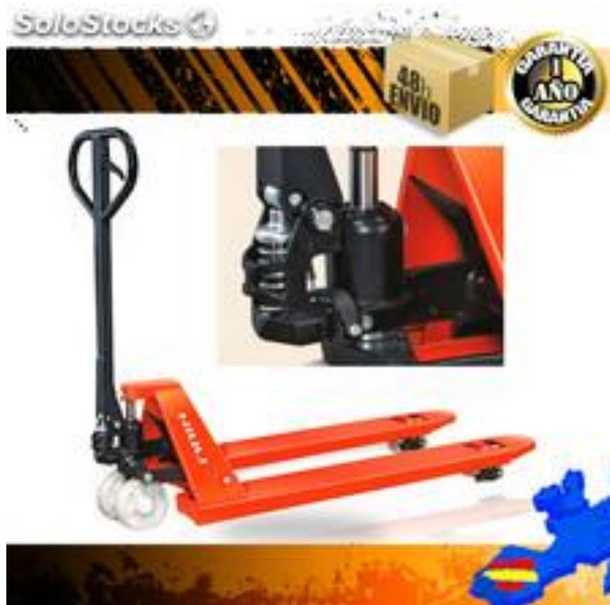
**Características:** Capacidad (kg): 2000, Altura Min. desde el suelo (mm): 75, Altura Max. desde el suelo (mm): 185, Altura de elevación (mm): 110, Longitud de horquilla (mm): 1150, Anchura de horquilla (mm): 160, Anchura total de horquillas (mm): 550, Timón (mm): 160x50, Peso (kg): 65.
