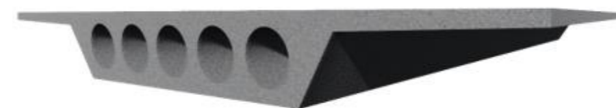
Figura 5. Sección del tablero
