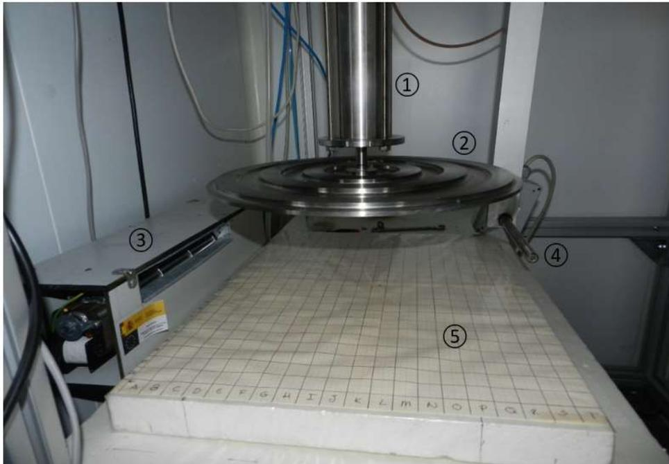
**Figura 7.** Sistema de generación y aplicación de ultrasonidos **1.** Transductor piezoeléctrico. **2.** Plato emisor escalonado. **3.** Ventilador. **4.** Anemómetro. **5.** Superficie de tratamiento.
