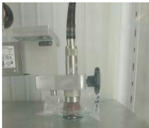
Figura 3.8. Medida de ultrasonidos de señal, colocación de los transductores
