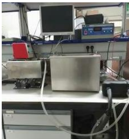
Figura 3.6. Montaje experimental del baño ultrasónico para el tratamiento térmico
