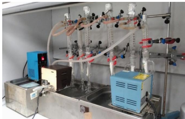
Figura 3.13. Montaje experimental para análisis de grasa de las muestras tratadas
