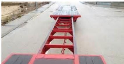
*Ilustración 77. Camión con plataforma extensible. 2016. Fuente Transgruas*
