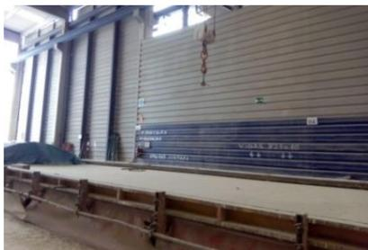
*Ilustración 26. Pistas hormigonado paneles de cerramiento. 2016. Fuente propia*
