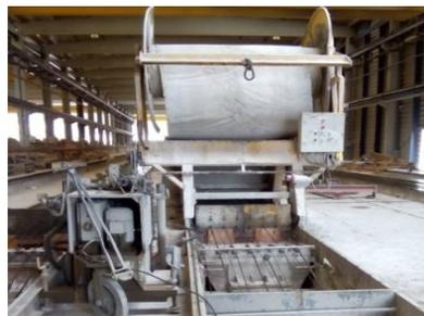
*Ilustración 19. Máquina extrusora. 2016. Fuente propia*
