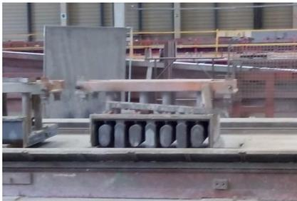
*Ilustración 22. Cassete para efectuar orifios en las placas. 2016. Fuente propia*
