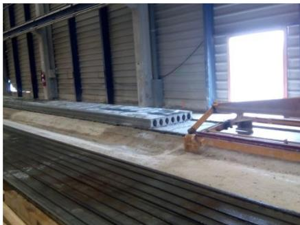
*Ilustración 20. Extrusora de hormigón.
