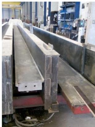
*Ilustración 17. Encofrado vigas. 2016. Fuente propia*
