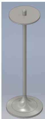
*Fig. 4.49 Válvula del sistema de distribución.*
