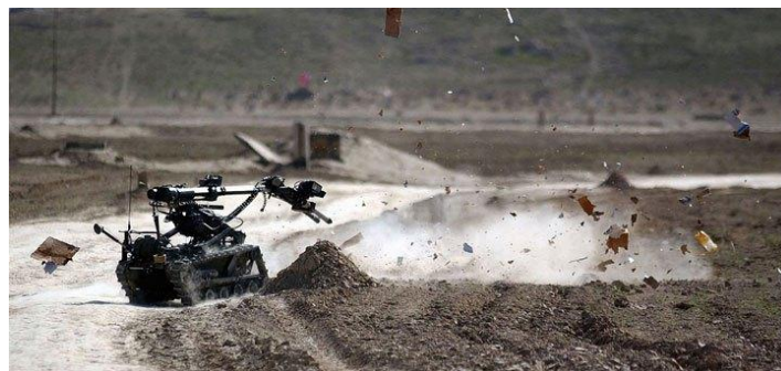
Imagen 2. Robot teleoperado para desactivar explosivos [5]
