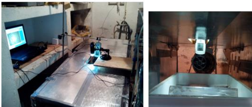
Figura 44. Interior de la cámara y aparatos conectados al ordenador (izquierda) e interior de la mampara con molde vacío (derecha)
