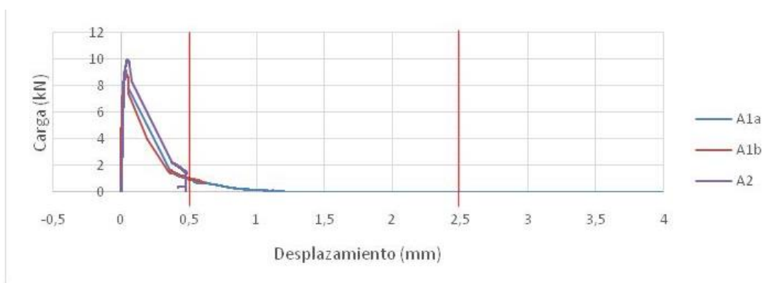
Figura 67. Gráfica de resultados de las probetas de control de ensayo de flexotracción a 3 puntos.
