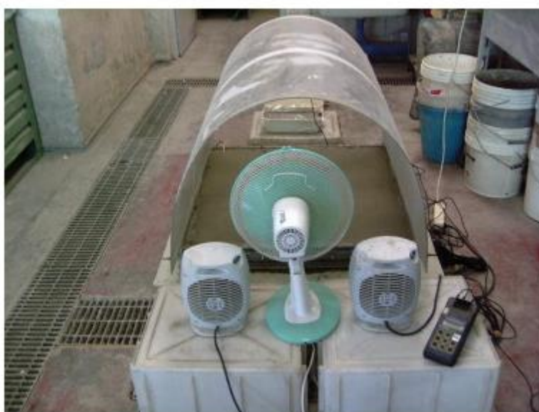
Figura 26. Configuración de ensayo de retracción por secado [24].
