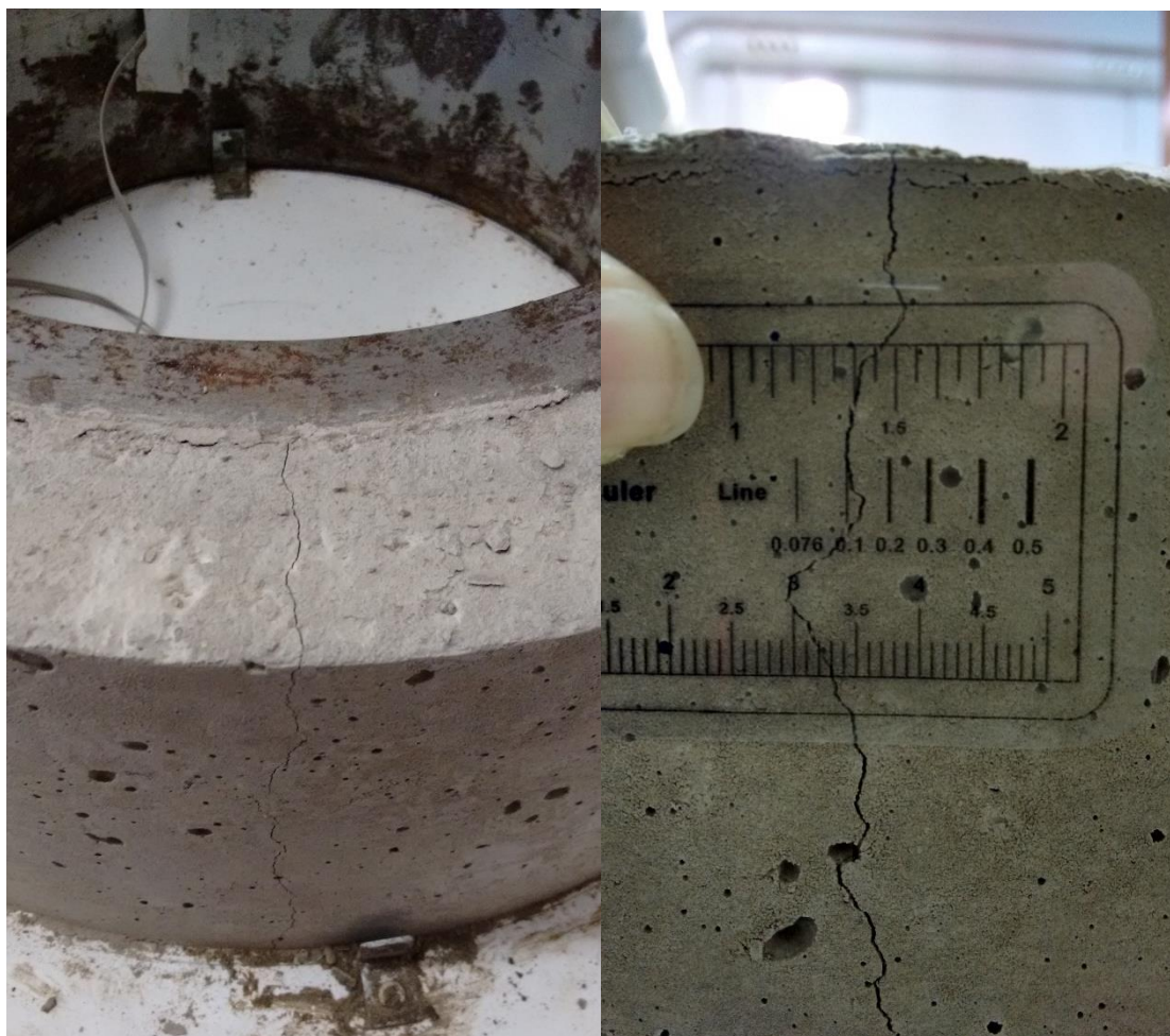
Figura 63. Fisuras aparecidas en los ensayos de anillo restringido.
