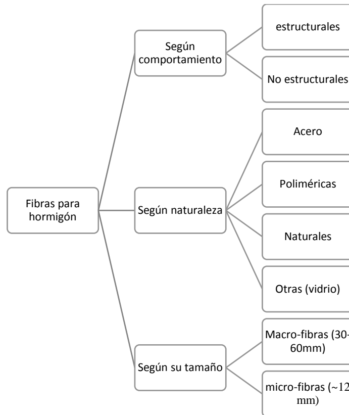
Figura 4. Clasificación de las fibras para hormigón.
