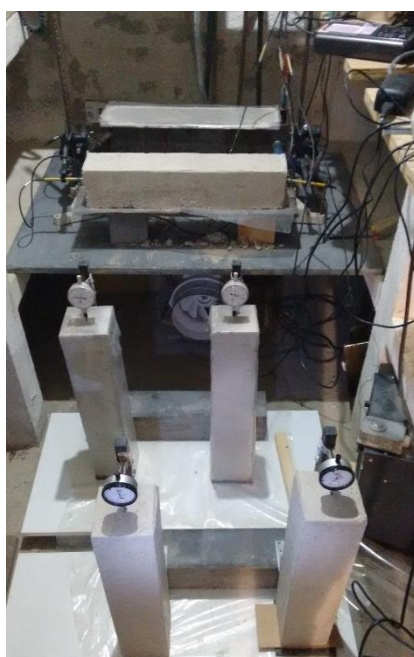
Figura 37. Montaje de ensayo de retracción libre durante la fase experimental.
