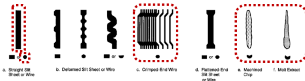
Figura 6. Posibles geometrías para fibras metálicas [1] – se señalan las geometrías utilizadas en este estudio.
