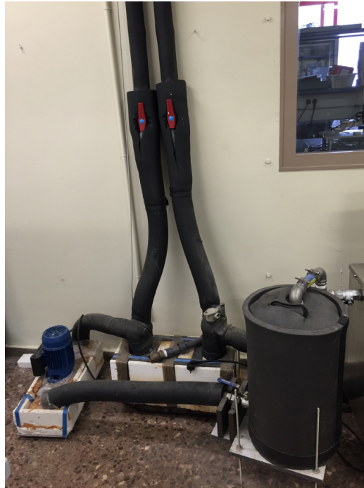
Figura 11| Detalle del intercambiador y depósito pulmón del sistema de refrigeración del baño de ultrasonidos.
