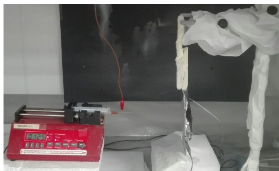
Figura 3.1: Equipo de electrohilado, CBIT.
