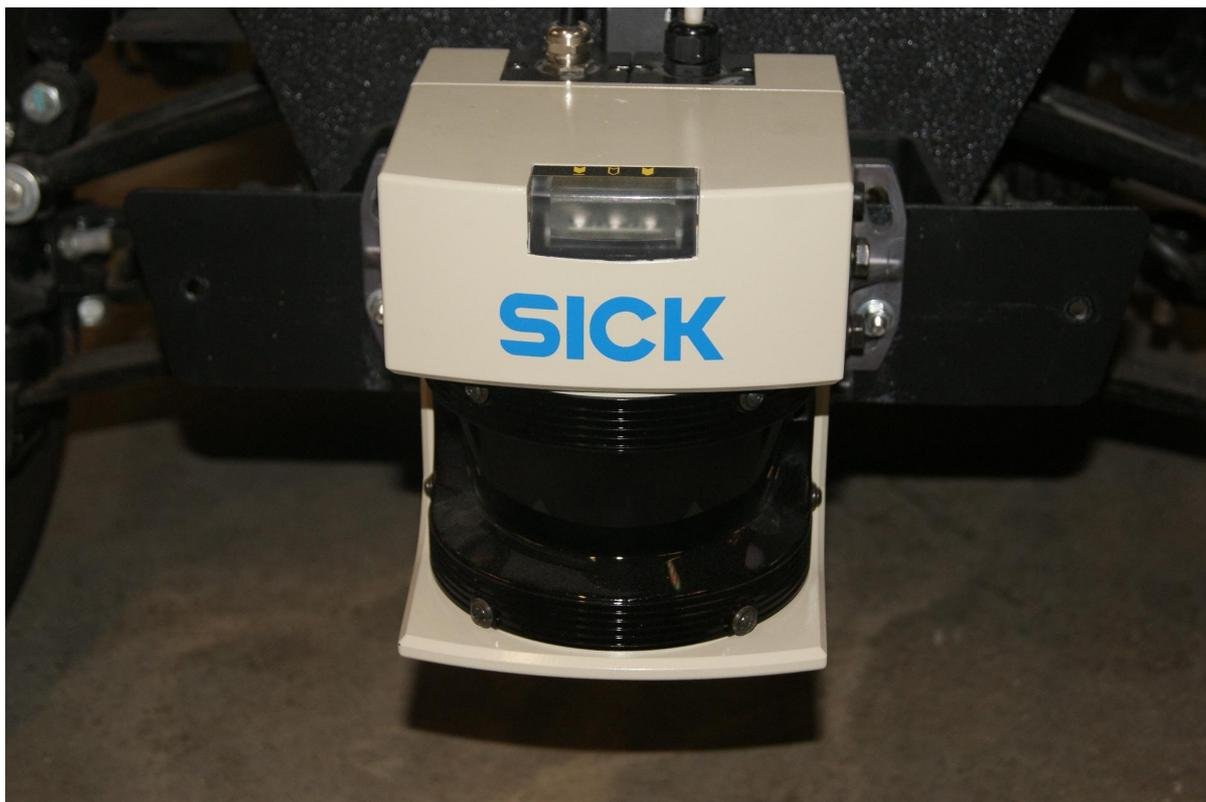
Figura 3.5 Sensor láser Sick LMS 291-S05
