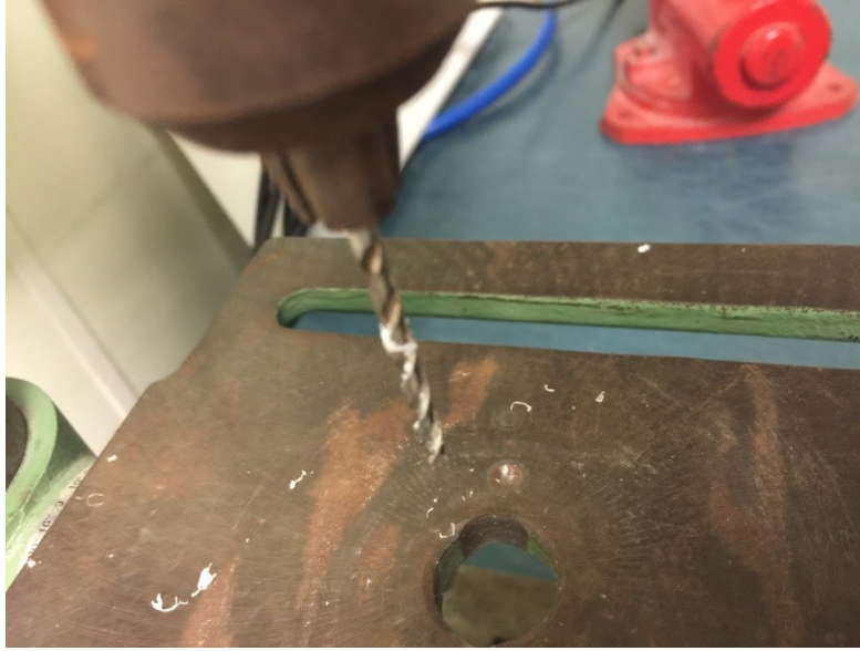
Figura 3.36 Detalle viruta de PLA adherida a la broca
