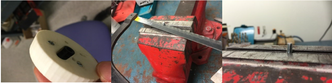
Figura 3.50 Distintas operaciones para evitar interferencia de tornillos en movimiento articular
