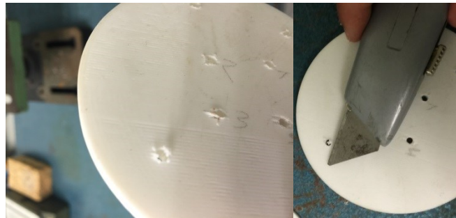
Figuras 3.37 y 3.38 Detalle deformación y corrección del PLA tras taladrado
