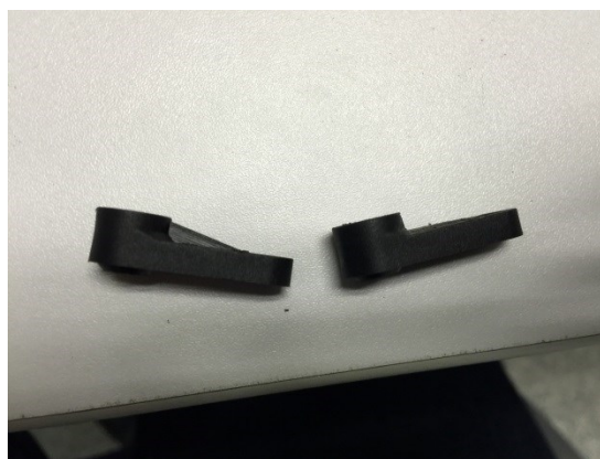
Figura 3.49 Detalle piezas servomotor antes y después de limado
