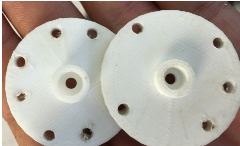
Figura 3.48 Detalle piezas de PLA para articulaciones desgastadas tras pruebas
