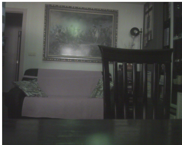
Figura 13. Imagen tomada con la webcam con dos filtros polarizados rotados. No hay píxeles saturados.
