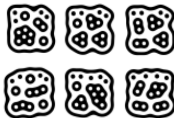
Figura 2. Ejemplo de imágenes fiduciales utilizadas por reactIVision
