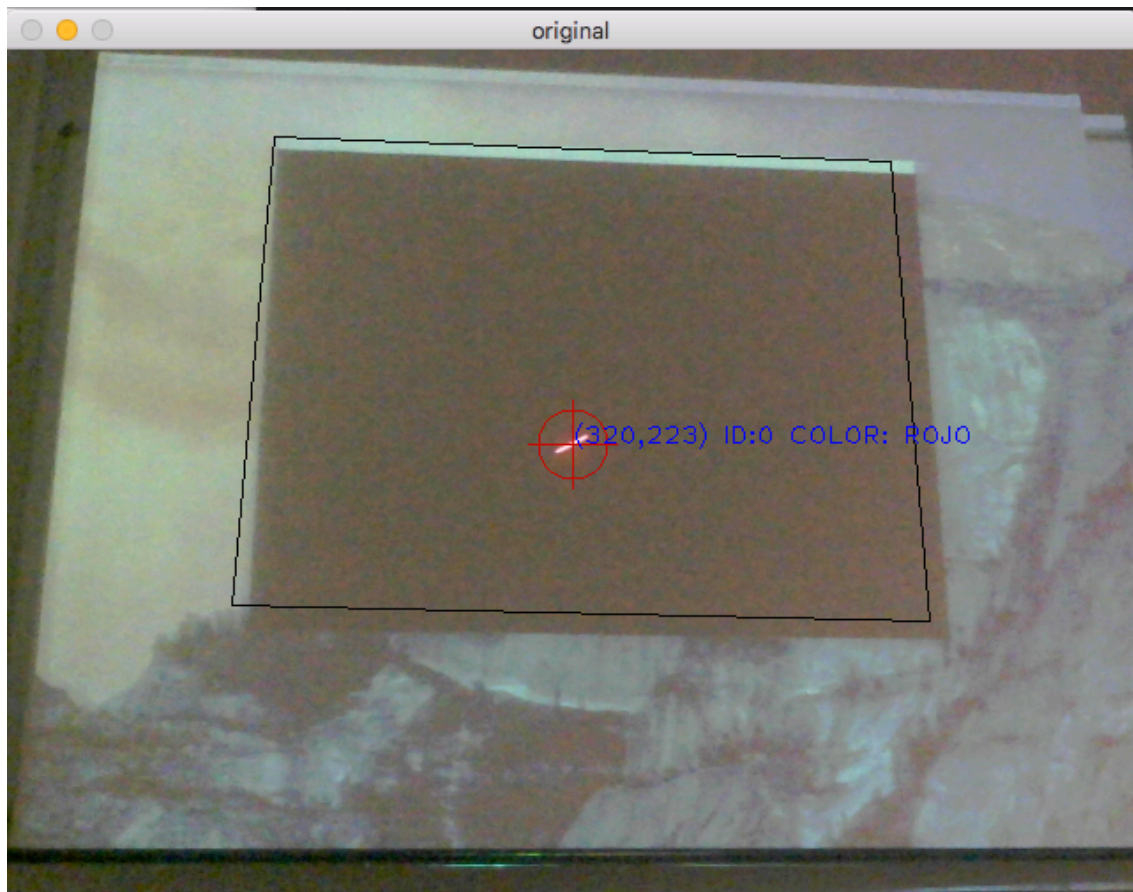
Figura 43. Pruebas con fondo negro, no tan iluminada y con filtro. Resultado perfecto.
