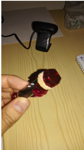
Figura 22. Puntero láser con un trozo de papel transparente del mismo color
