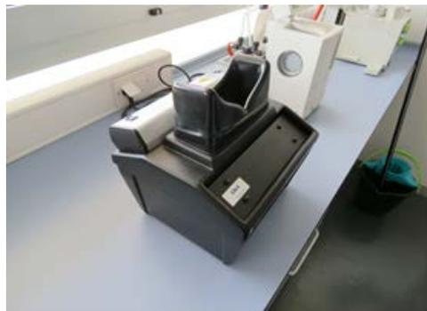
Figura 24. Lámpara UV con cabina de visualización (Vilbert Lourmat 254 y 365 nm)
