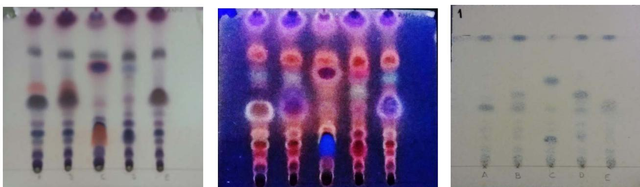
**Figura 26.** Cromatogramas obtenidos utilizando los tres reactivos mencionados anteriormente en su orden respectivo (vainillina, anisaldehído sulfúrico y ácido fosfomolibdico).
