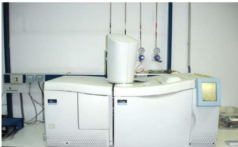
**Figura 16.** Fotografía de cromatógrafo de gases y un detector de masas Clarus 500 GC-MS
