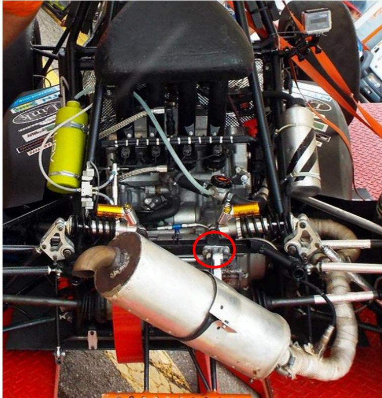
Figura 7 Tensor de cadena mediante pletinas separadoras utilizado en el prototipo FSUPV-01 [3].
