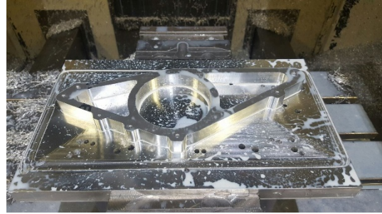
Figura 57 Proceso de fabricación del porta diferencial izquierdo en vivo.
