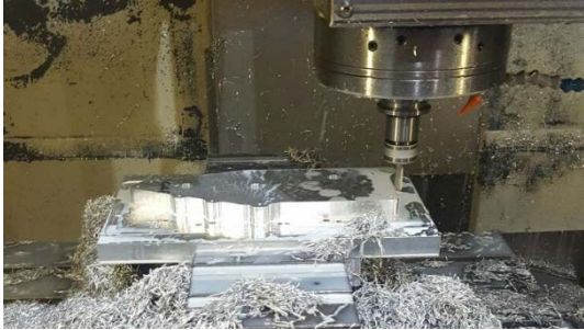
Figura 57 Proceso de fabricación del porta diferencial izquierdo en vivo.
