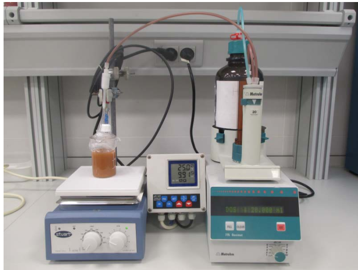
Figura 19 Montaje del equipo 1 para el ensayo de ANC
