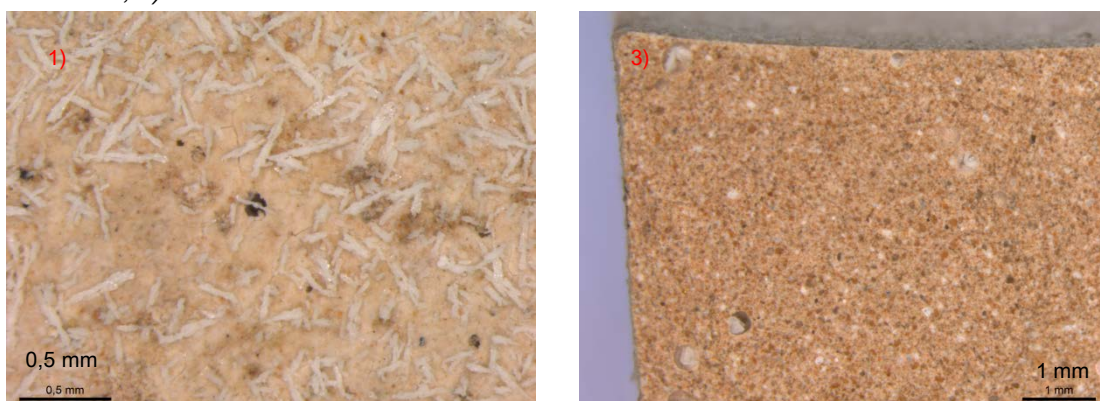
Figura 26 Microscopía óptica RC; 1) Muestra sin atacar 25 aumentos; 2) Muestra atacada 25 aumentos; 3) Corte transversal sin atacar 10 aumentos; 4) Corte transversal atacado 10 aumentos; 5) Corte transversal atacado revelado con fenolftaleína.
