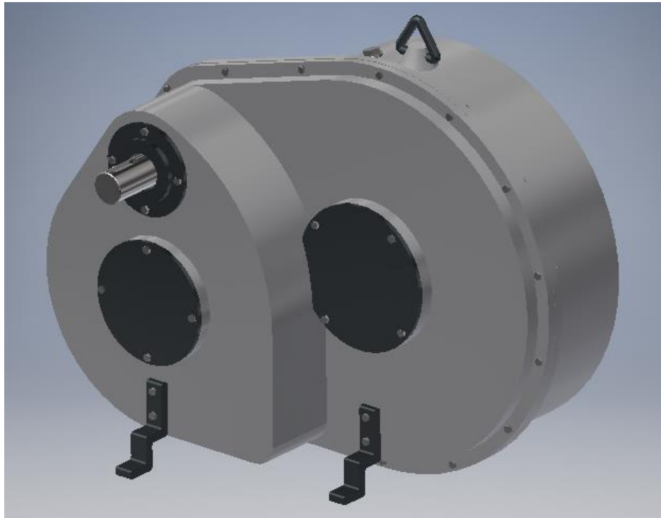
Figura 9 – Montaje completo del reductor y forma de la carcasa
