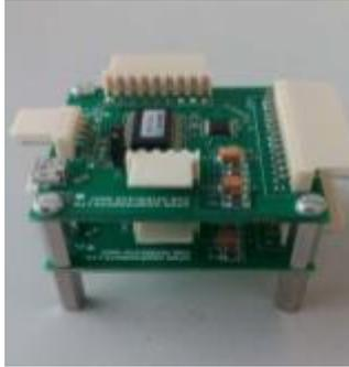
Fig. 14 Dos placas interfaz de joystick USB montadas en torre. Fuente: IDF (2006) [2]
