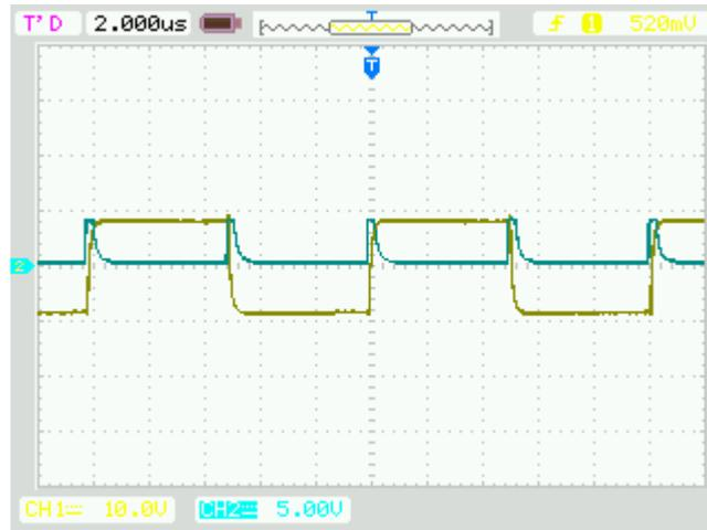
Figura 4.21 Señal de reloj (azul) frente a la señal alterna a la salida del DG403 (amarillo)
