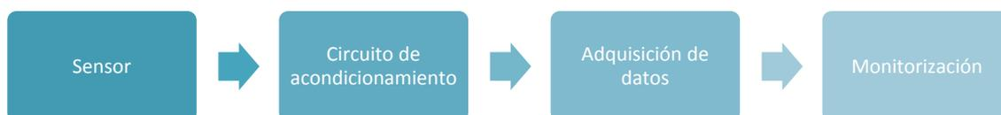
**Figura 3.1:** Diagrama de bloques de las etapas del sistema de medida.
