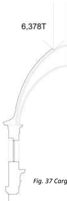
Fig. 37 Carga puntual vertical de la linterna
