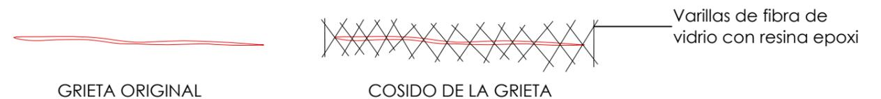
Figura 3. Detalle del cosido de grietas (Fuente propia)
