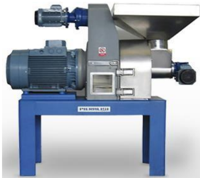
Figura 4.15. Molino de martillos. www.pieralisi.com
