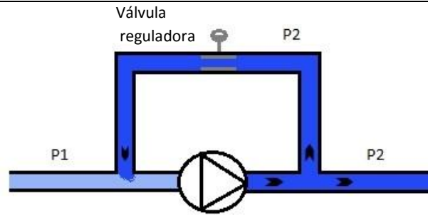
Figura 4.11 Esquema de representación del Bypass a la bomba.
