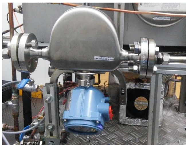
Figura 5.3 Colocación del caudalímetro del circuito de refrigerante.
