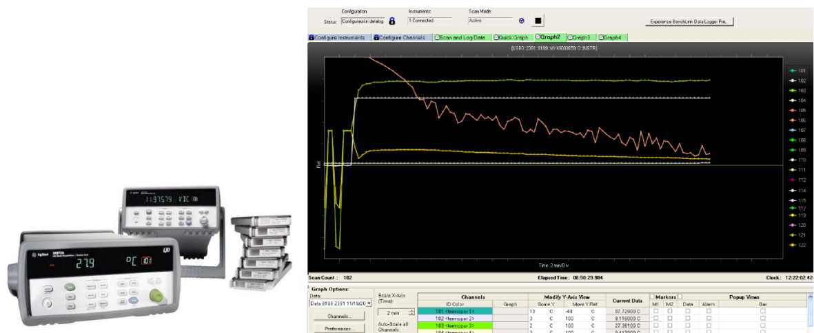
Figura 4.23 Data logger de Agilent 34970A(izquierda) y captura de pantalla software BenchLink Data Logger 3 (derecha).
