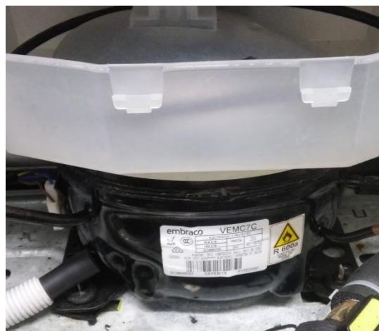
Figura 4.3 Compresor Embraco utilizado en la instalación experimental.
