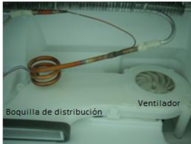
Figura 4.5 Ventilador encargado de la distribución de aire.
