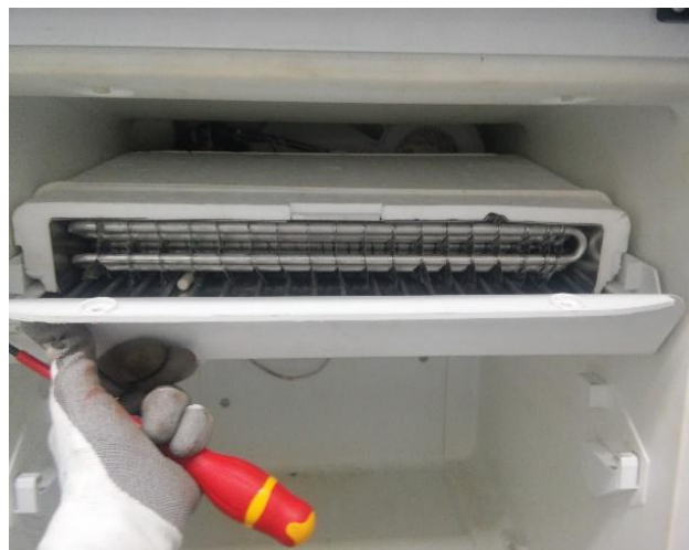
Figura 4.4 Compartimento del evaporador doméstico utilizado.
