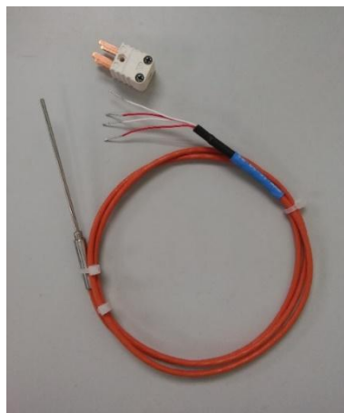
Figura 4.18 PT100 utilizada en la instalación experimental.
