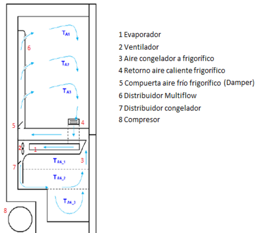
Figura 3.15 Funcionamiento frigorífico con sistema No Frost.
