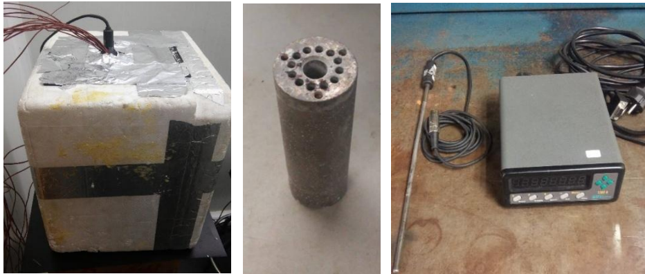
Figura 5.11 Dispositivos utilizados para la comprobación de los termopares de la instalación.
