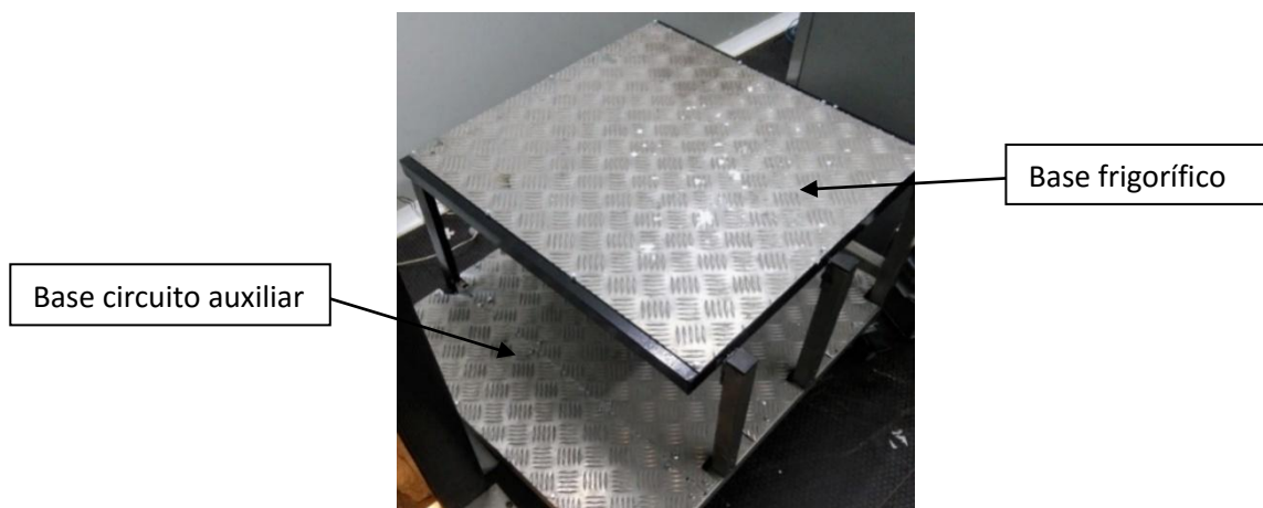
Figura 5.7 Base para la colocación del circuito auxiliar y frigorífico.
