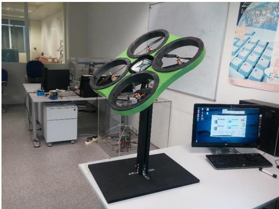
*Ilustración 42. Base de pruebas con quadrotor acoplado.*
