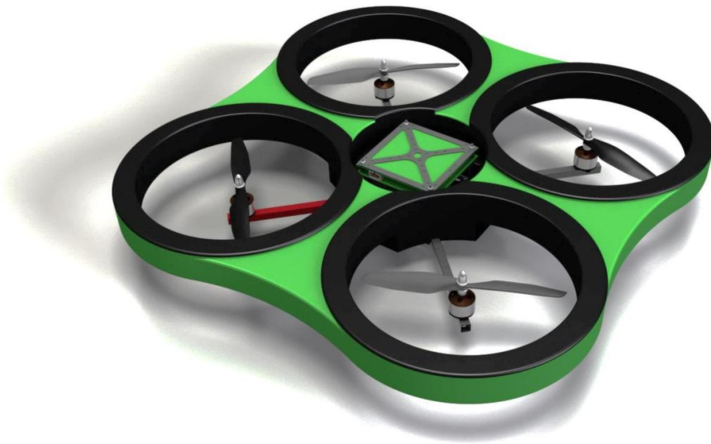
*Ilustración 47. Diseño 3D del quadrotor con carcasa.*
