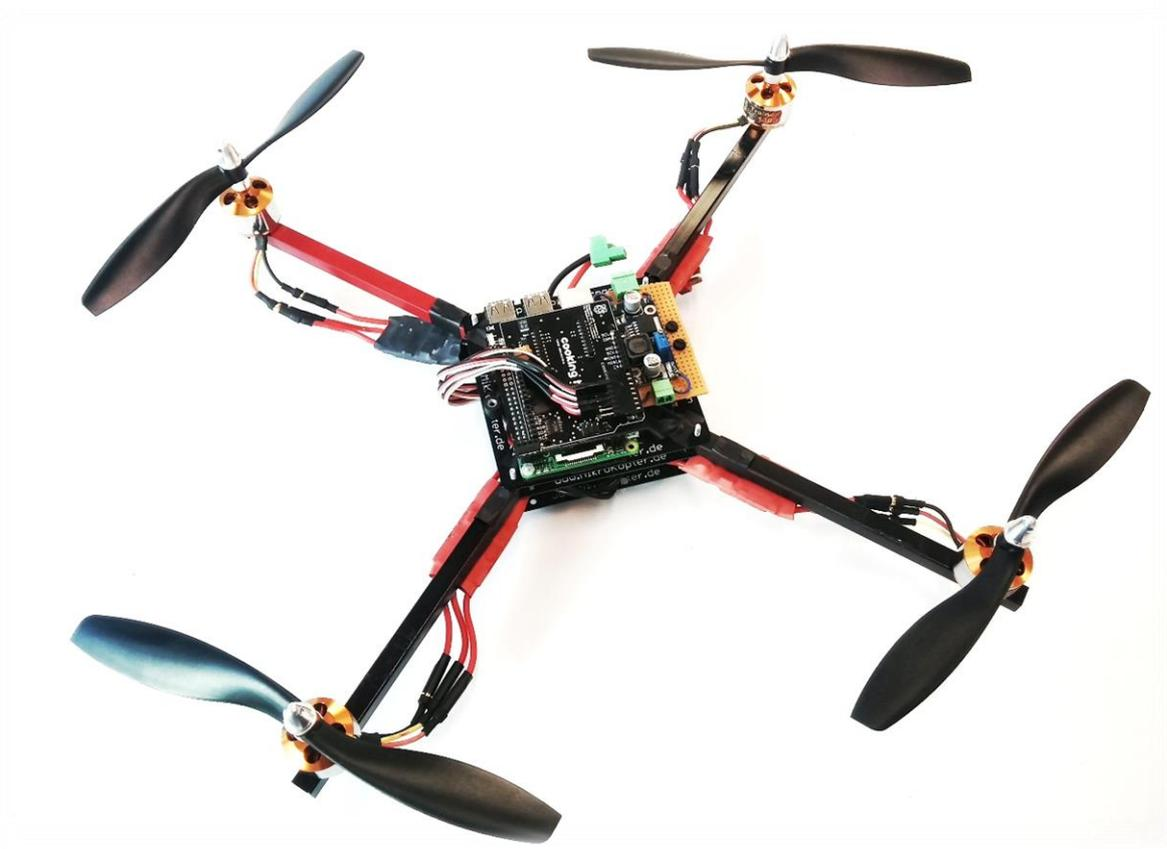
*Ilustración 28. Montaje con el convertidor de tensiones incluido.*
