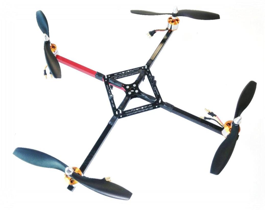
*Ilustración 21. Montaje de los motores y hélices sobre el chasis.*
