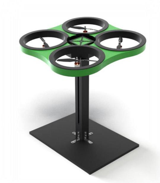
*Ilustración 48. Diseño 3D de la plataforma de pruebas completa.*
