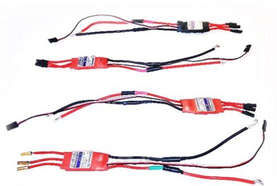
*Ilustración 22. Drivers Turnigy Basic 25A usados en el trabajo.*
