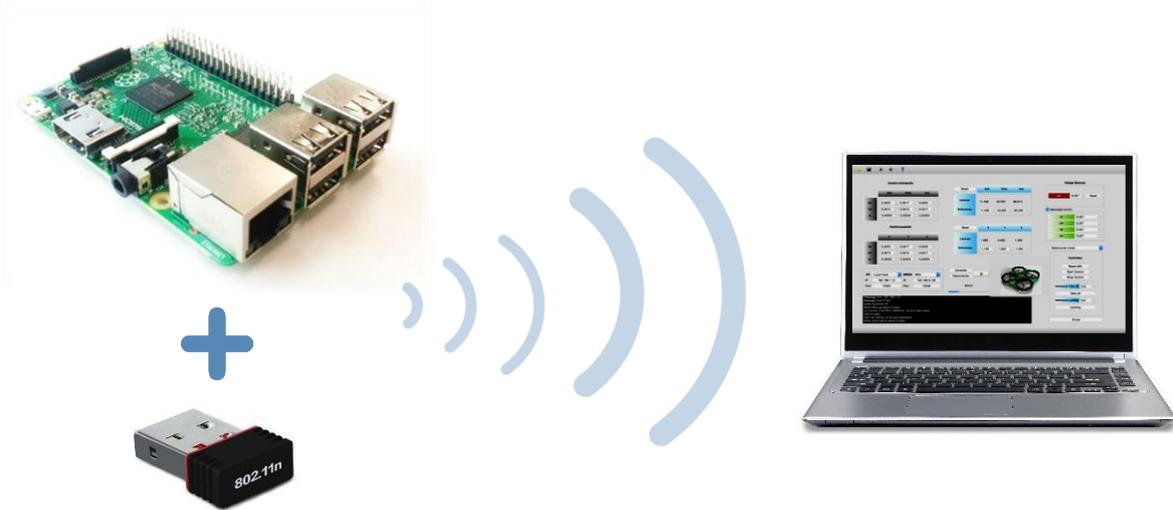
Ilustración 40. Esquema de conexión UDP entre Raspberry y el PC Base.
