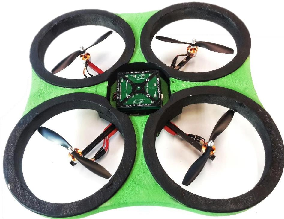
*Ilustración 33. Montaje completo del quadrotor (con protección).*
