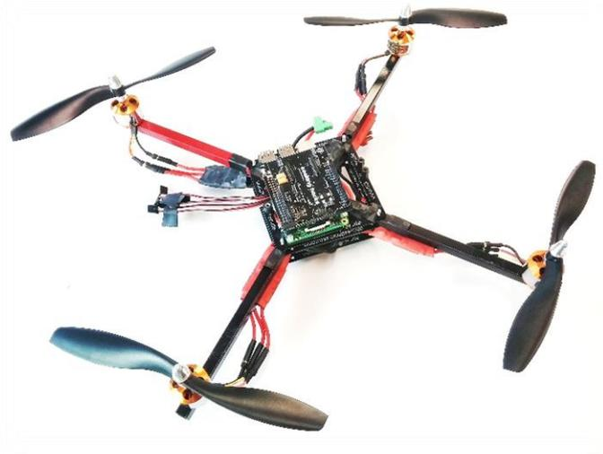
*Ilustración 27. Montaje del conjunto quadrotor con el puente de conexiones instalado.*
