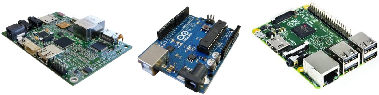
Ilustración 12. IGEPv2, Arduino UNO, Raspberry Pi 2.
