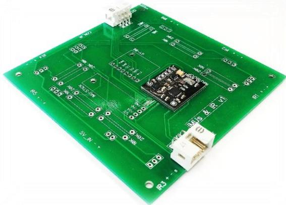
*Ilustración 30. 10 DOF IMU Sensor usado en el trabajo.*
