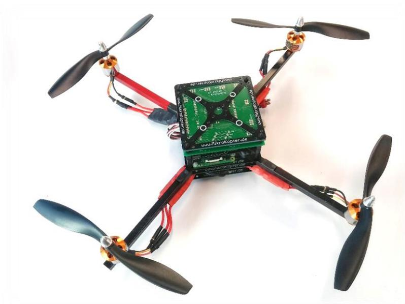
Ilustración 32. Montaje completo del quadrotor (sin protección).
