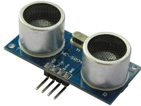
Ilustración 10. Sensor de ultrasonidos HC-SR04, cortesía de Cytron Technologies.
