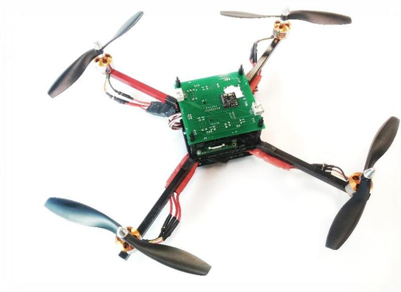
Ilustración 31. Montaje de la IMU sobre el quadrotor.
