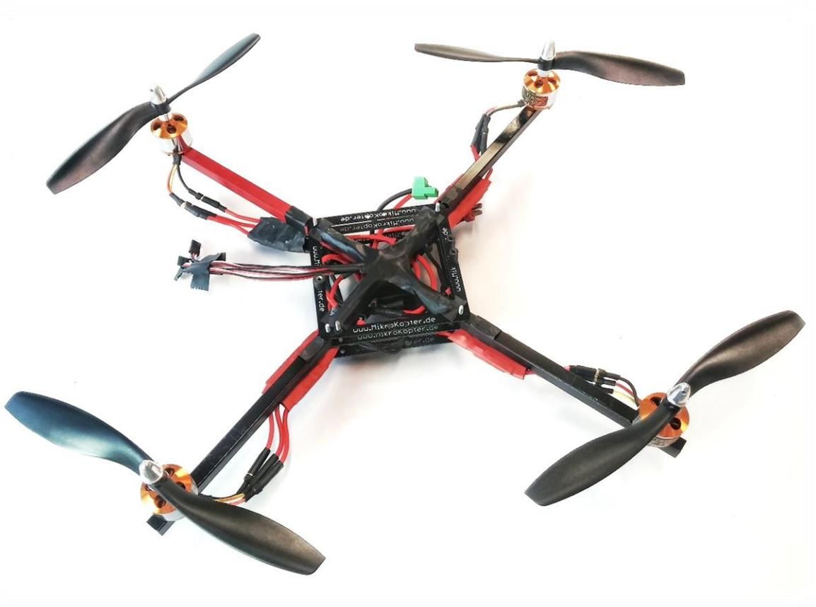
*Ilustración 23. Montaje del chasis con motores y drivers instalados.*
