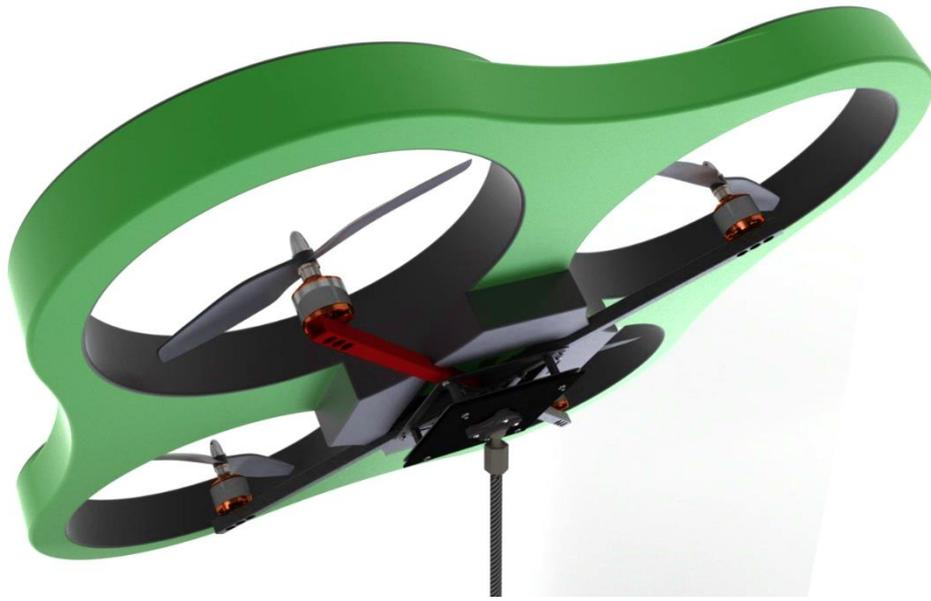
Ilustración 49. Imagen del diseño 3D de la unión entre el quadrotor y la base.
