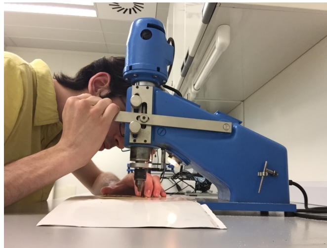
Figura 48. Proceso de taladrado de la placa
