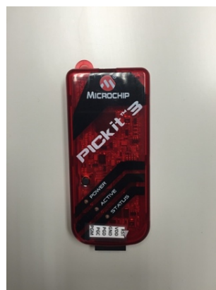
Figura 36. Controlador de interfaz periférico usado para la programación de la placa externa al circuito de medida de bioimpedancia.
