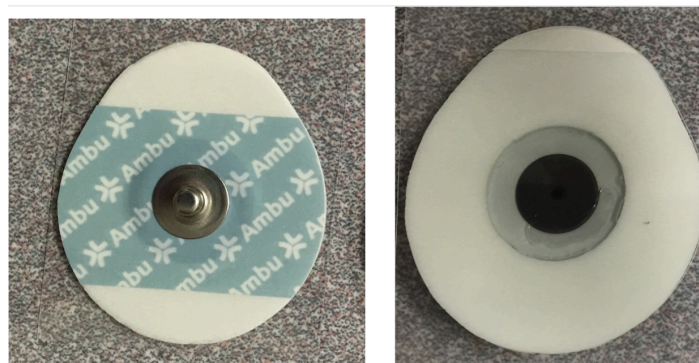
Figura 11. Electrodo de Ag-AgCl. Cara de conexión al cable, a la izquierda. Cara de contacto con la piel, a la derecha.
