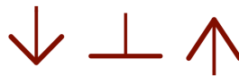
Figura 17. Símbolos de la alimentación en los componentes del circuito. De izquierda a derecha: V-, GND y V+.
