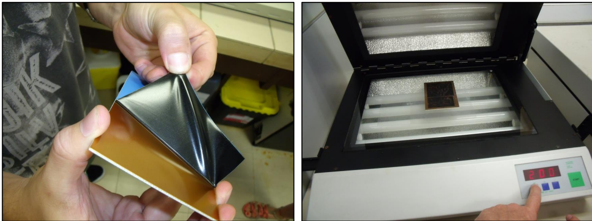
Figura 5.27: Preparación para el proceso de insolación de la placa.
