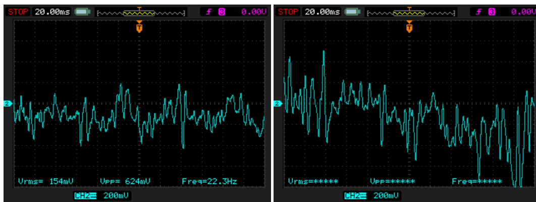
Figura 6.20: Señal en el bíceps al flexionar el brazo con distintas cargas (2Kg y 5,6 Kg).
