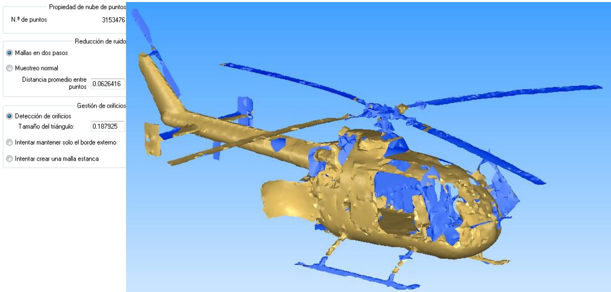
Figura84. 1er paso mallado
