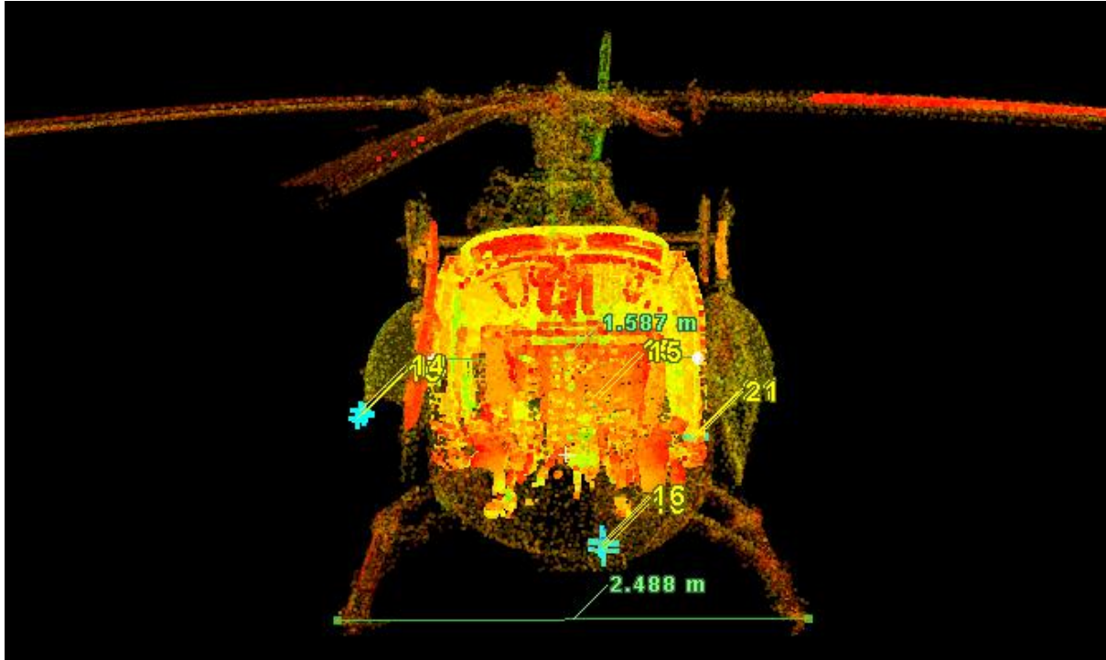
Figura 69. Medidas en Cyclone de ancho del helicóptero
