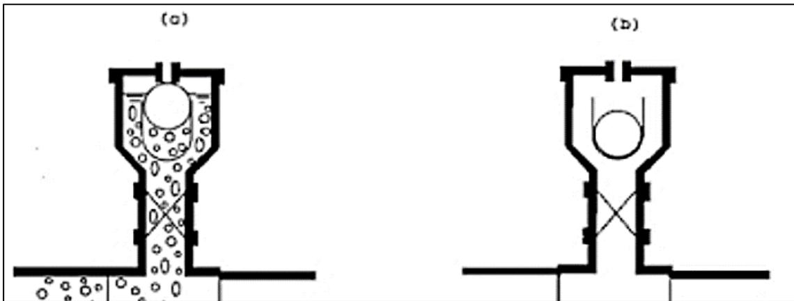
Figura 2- (a) Flotador arriba (bloqueo) - (b) Flotador abajo ([www.construmática.com](http://www.construmática.com))
