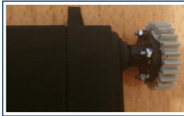
Figura 13. Fijación del engranaje
