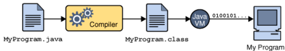
Figura 2. Arquitectura general de un programa en ejecución en una JVM
