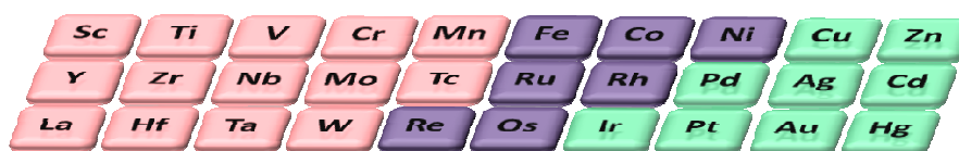
Figura 1.5: Grupos de metales de transición agrupados según su capacidad de disociar CO, H_2 ó CO e H_2 .
