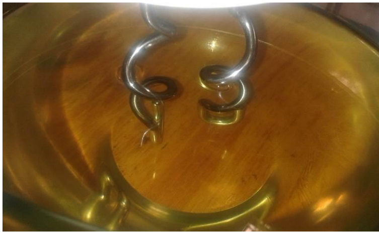
Figura. 77. Centrado de las aspas del agitador comercial.
