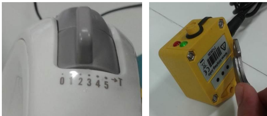
Figura. 84. Regulador del agitador comercial, e iniciación manual de un data logger mediante un imán.
