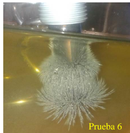
Figura. 99. Partículas retenidas por el sensor en las pruebas mixtas.
