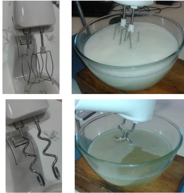
Figura 74. Configuraciones del agitador comercial y estado del aceite.
