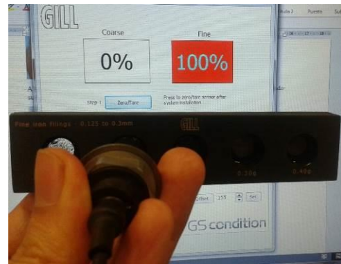
Figura. 111. Verificación de las diferentes posiciones de la regleta de calibración.
