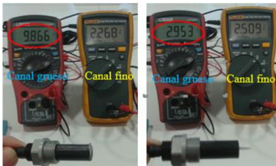
Figura 116. Medida de partícula gruesa plana dos posiciones.
