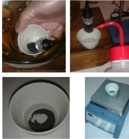
Figura. 88. Extracción de la muestra retenida por el sensor.
