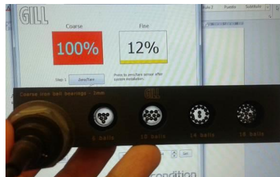
Figura. 107. Verificación de la regleta de calibración.
