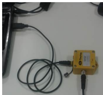
Figura 57. Conexión a PC para la configuración de los data logger.
