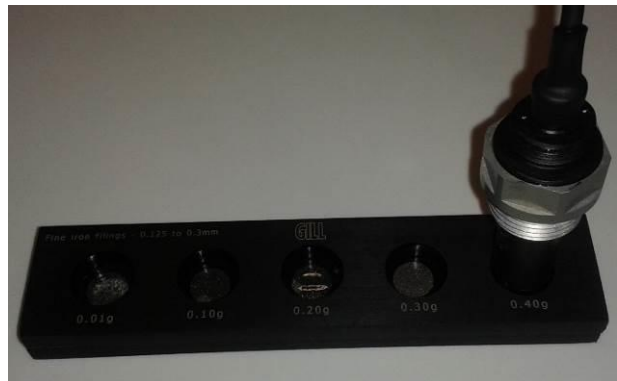
Figura. 31. Calibración del canal fino.
