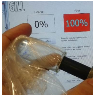
Figura. 110. Uso de una pequeña masa de partículas finas como límite de calibración del canal fino.
