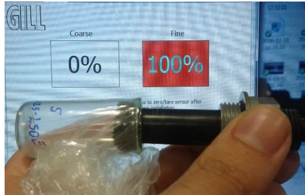
Figura. 108. Uso de una gran masa de partículas finas como límite de calibración canal fino.
