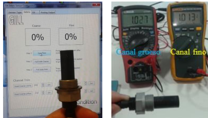
Figura. 29. Tarado o Acerado del sensor.
