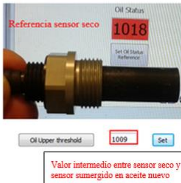
Figura. 35. Número de referencia para establecer la condición sensor sin aceite.
