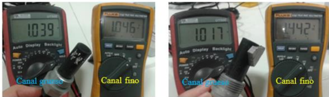
Figura. 117. Señal adhiriendo las partículas en los laterales del sensor.
