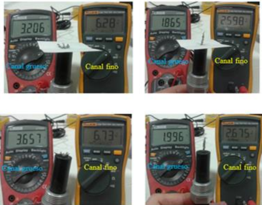
Figura 56. Verificación de la señal por interponer una lámina de papel.
