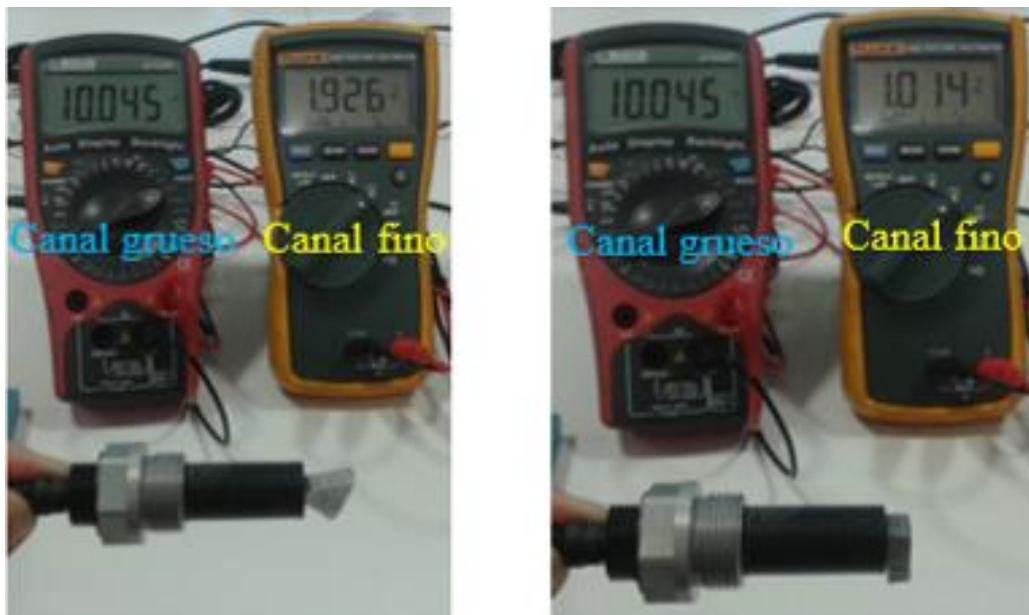
Figura 115. Medida de partícula grande isomorfa en dos posiciones.
