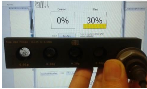
Figura. 109. Verificación de las diferentes posiciones de la regleta de calibración.
