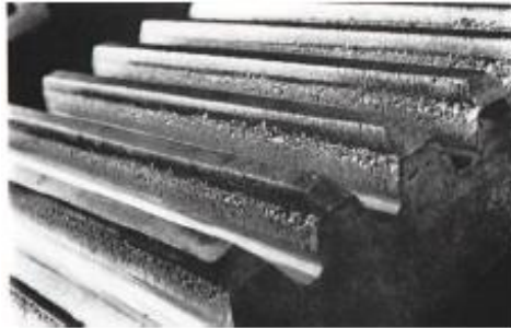
Figura. 10. Fenómeno del pitting.
