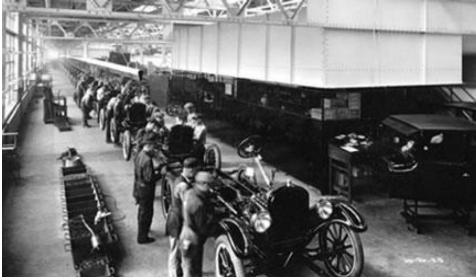
Ilustración 2. Fabricación en línea de montaje móvil de Ford (Fuente: UNAM, Universidad Nacional Autónoma México)
