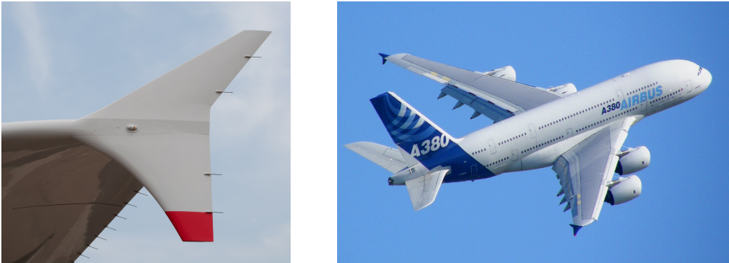
Figura 2.9: Wing tip fence (izq). A380-800 (dcha).
