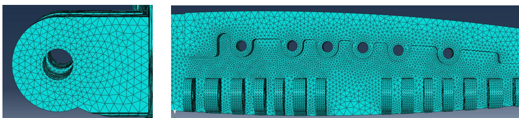
Figura 4.30: Detalles del mallado de las asas (izq) y de los agujeros superiores (dcha) de la unión ala-winglet correspondiente al winglet.
