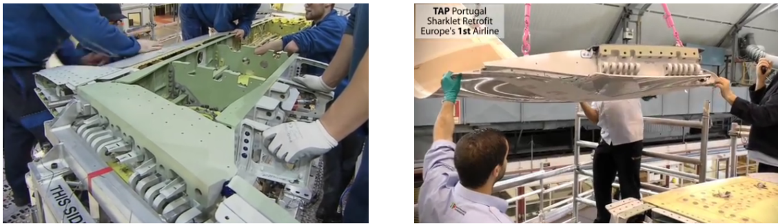
Figura 3.5: Unión ala-winglet. A la izquierda la parte correspondiente al ala. A la derecha la parte correspondiente al winglet.
