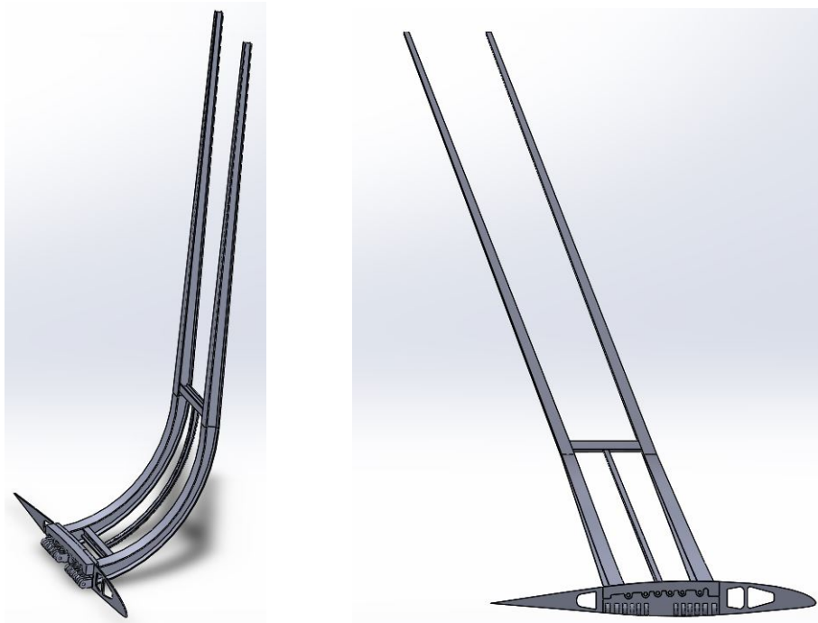
Figura 3.10: Estructura interna ensamblada a la costilla del winglet.
