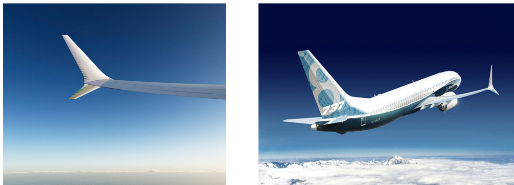
Figura 2.11: Split scimitar winglet (izq). B737 MAX (dcha).
