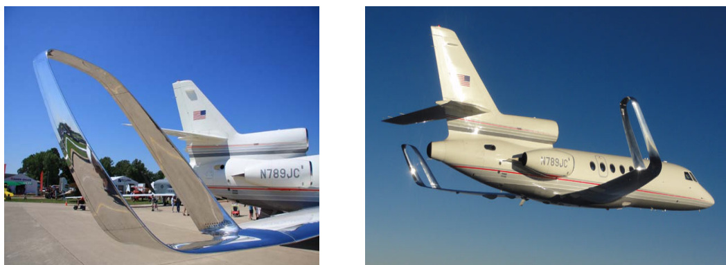
Figura 2.12: Spiroid winglet (izq). Falcon 50 (dcha).
