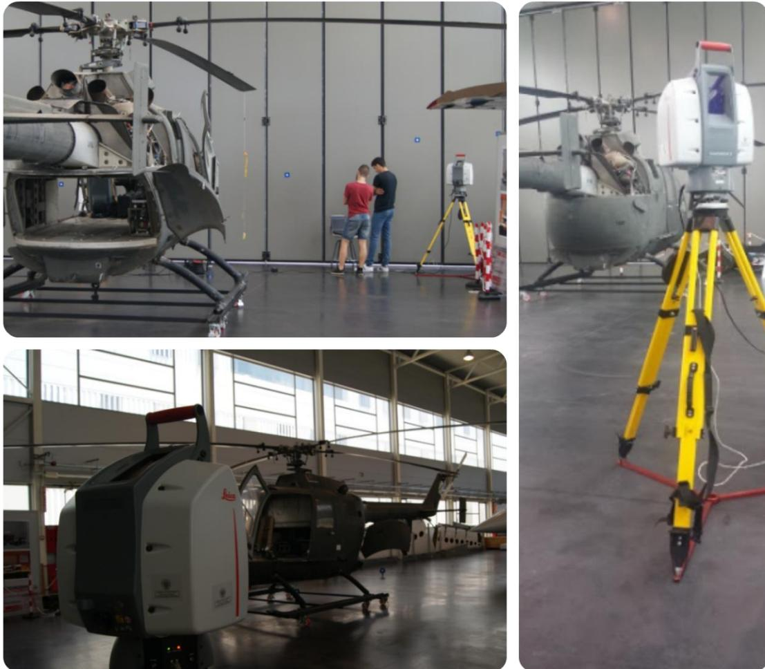
*Figura 6.7: Estacionamiento del láser escáner ScanStation 2*
