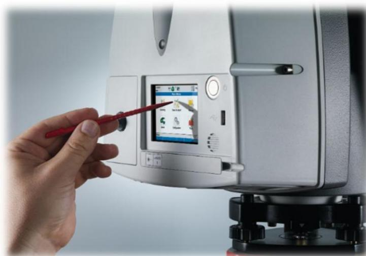
Figura 5.4: panel táctil equipo Leica P40
