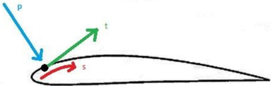
Figura 4.7: Presión y esfuerzos cortantes sobre una superficie aerodinámica
