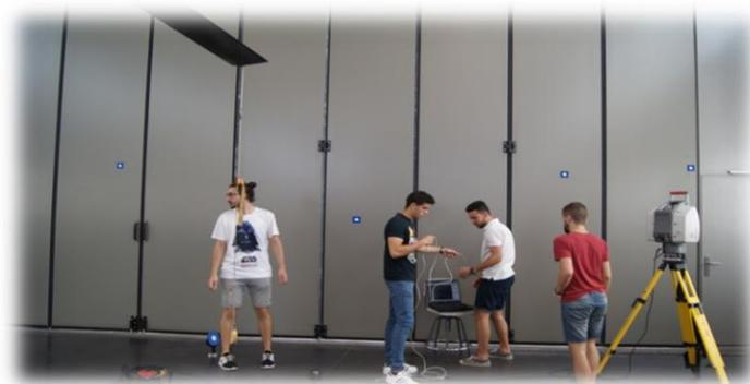
*Figura 6.27: Equipo colocando las dianas de trabajo*
