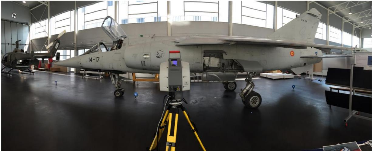
Figura 1. Escaneado del Mirage F1 mediante el Leica ScanStation 2
