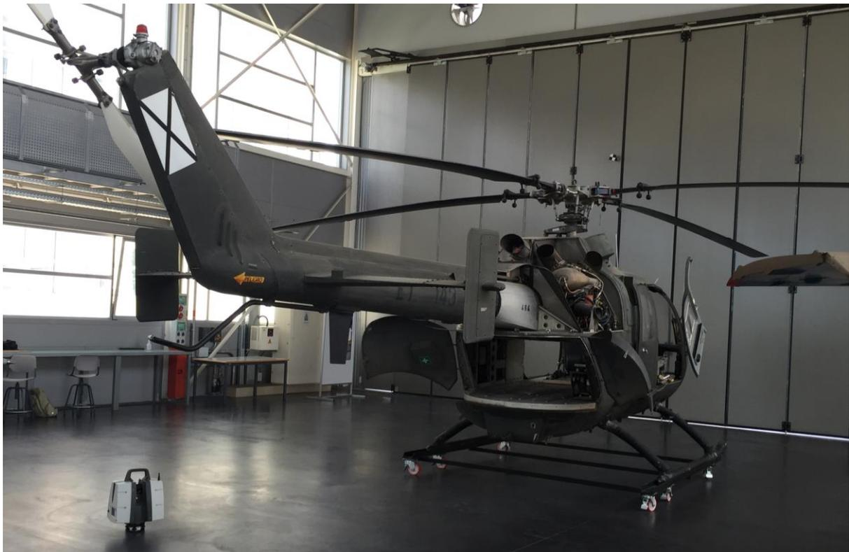
Figura 55. Leica ScanStation P40 realizando uno de los Escaneados Láser desde el Suelo
