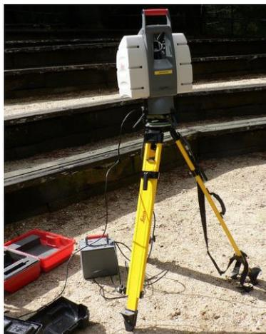
Figura 5. Ejemplo escáner láser estático: Leica ScanStation 2
