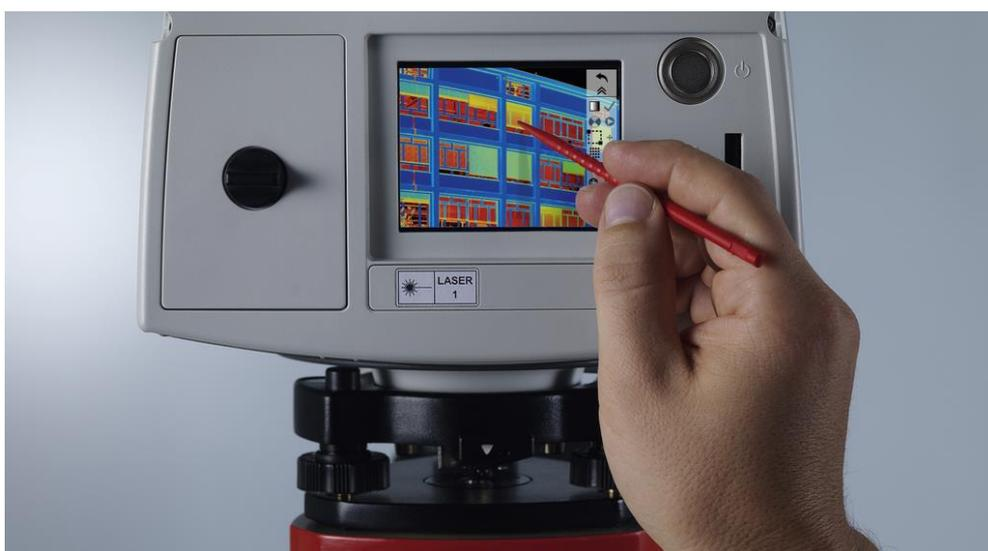
Figura 70. Representación del Escaneado 3D en la Pantalla Táctil del ScanStation P40
