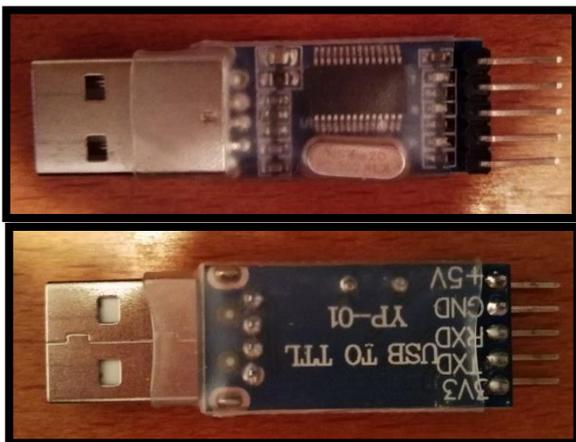
*Ilustración 59: Convertidor USB - serie*
