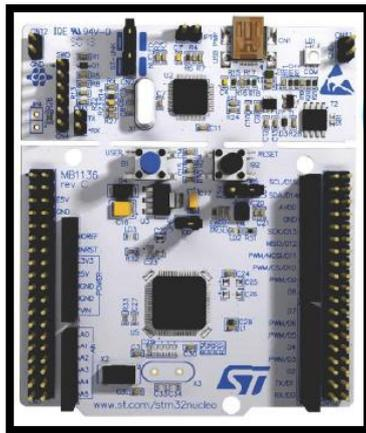
Ilustración 31: Microcontrolador STM32L053R8, [www.st.com](http://www.st.com)
