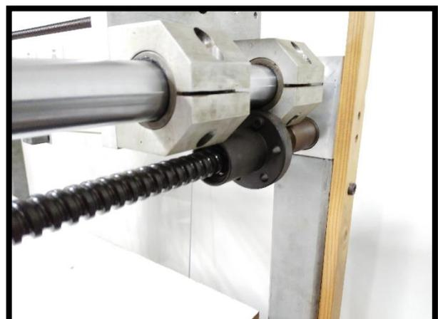
*Ilustración 49: Husillo y sistema de guiado eje X*
