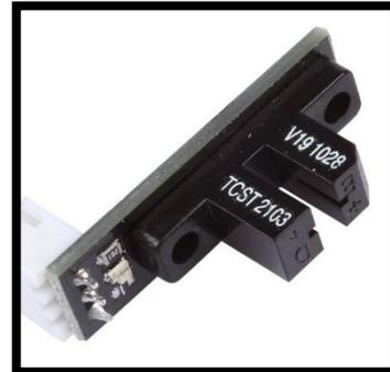
*Ilustración 12: Final de carrera óptico,
