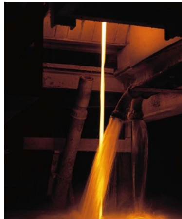
Figura 3.5: Fritado de la mezcla y Quenching
