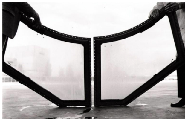
Figura 1.4: Parabrisas de un avión atacado por ceniza volcánica
