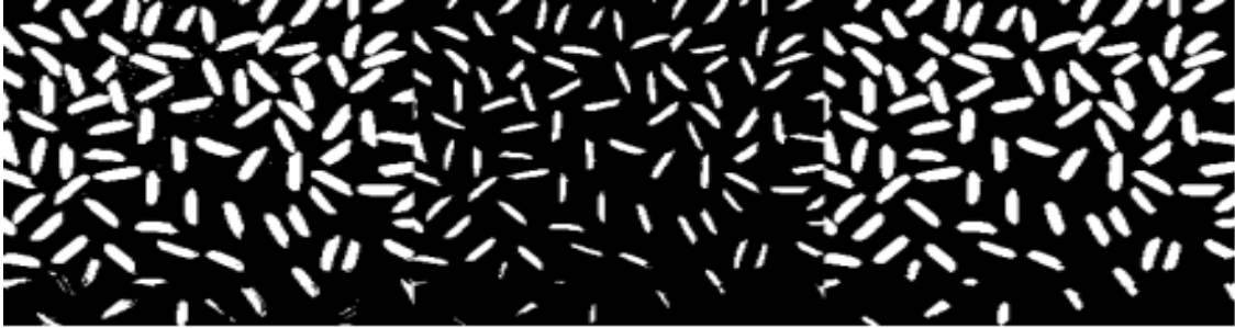
Ilustración 15. Efectos de la apertura en imágenes binarias
