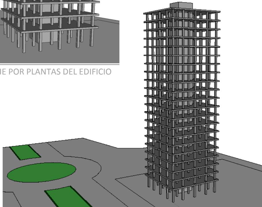
Fig. 62 | ESTRUCTURA COMPLETA DEL EDIFICIO
