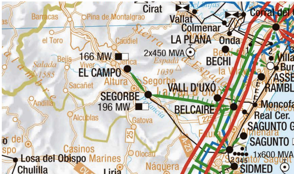
Figura I. Red de Alta Tensión de la comarca del Alto Palancia (Fuente: REE)
