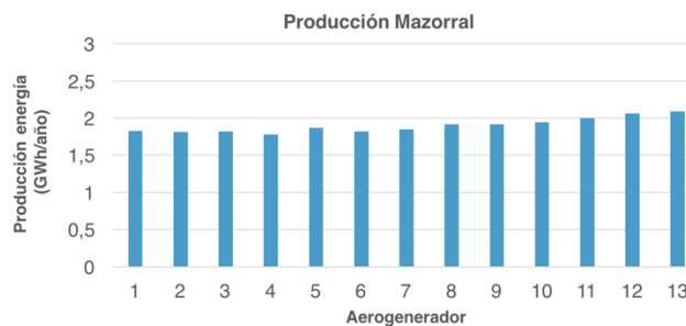
Figura 17. Producción por aerogenerador en el Alto del Mazorral (Fuente: Elaboración propia)
